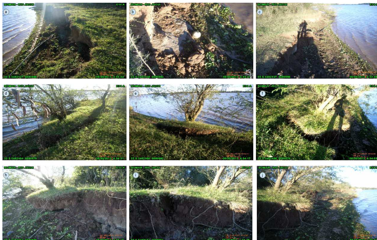
Figura 46. Marco E14 A localizado na Ilha do Araújo, margem esquerda do rio; todas as imagens desta figura mostram aspectos da erosão da margem/talude com evidência de um processo de desbarrancamento com a derrubada de um maricá. A fenda no barranco é evidente.
