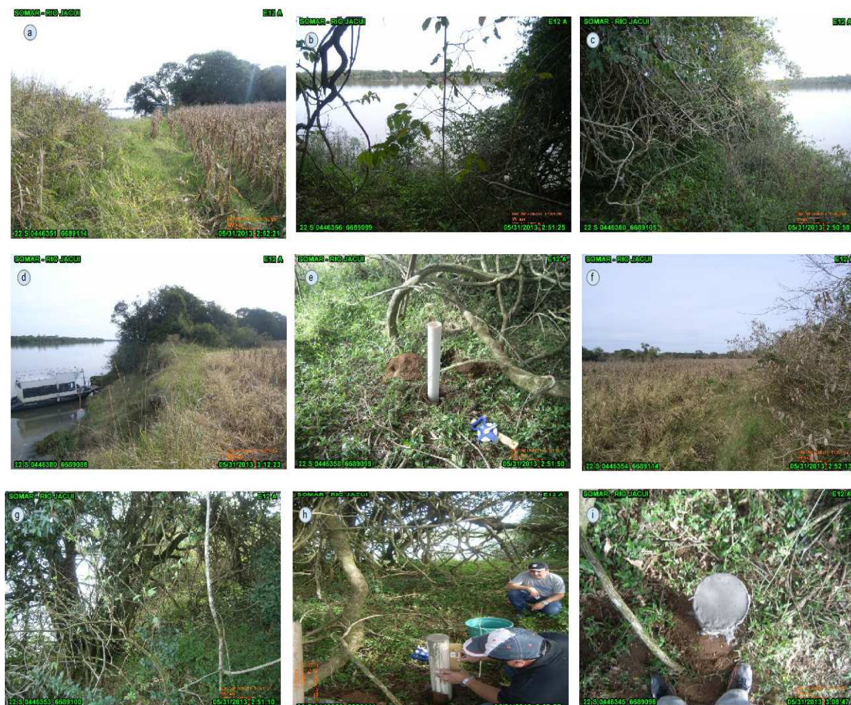
Figura 38. Marco E12 A localizado na ilha do Fanfa, margem esquerda do rio Jacuí; (a) vista da área para montante com plantação de milho e vegetação natural ciliar ao fundo; (b) vista do rio desde o marco; (c) margem para jusante; (d) vista do talude e do mato onde foi instalado o marco para montante; (e) marco sendo instalado; (f) vista do interior; (g) vegetação natural (Maricás) localizados no talude e sendo destruída; (h) concretagem do marco; (i) marco E12 A.
