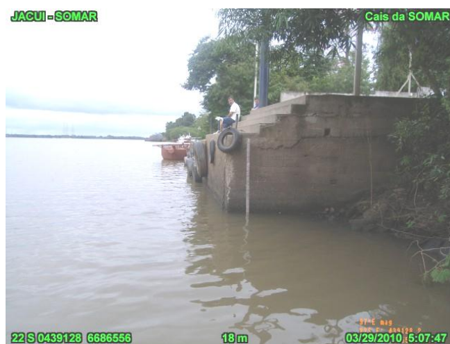
Figura 4. Régua de nível da instalada no cais da SOMAR tem como referencia o DATUM vertical de Imbituba-SC.
