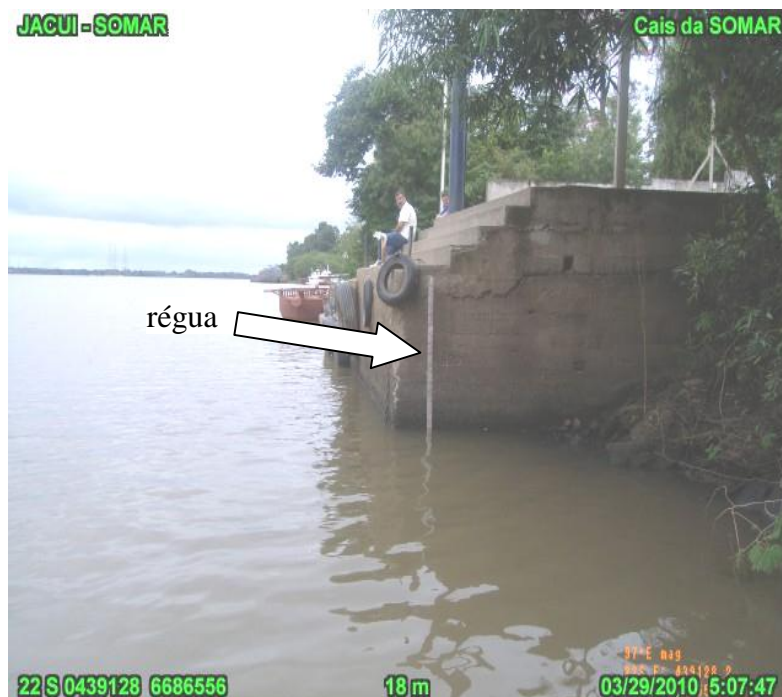
Figura 3. Régua de nível da instalada na tomada de água da Fazenda São José (FSJ), referencia DATUM vertical de Imbituba-SC.
