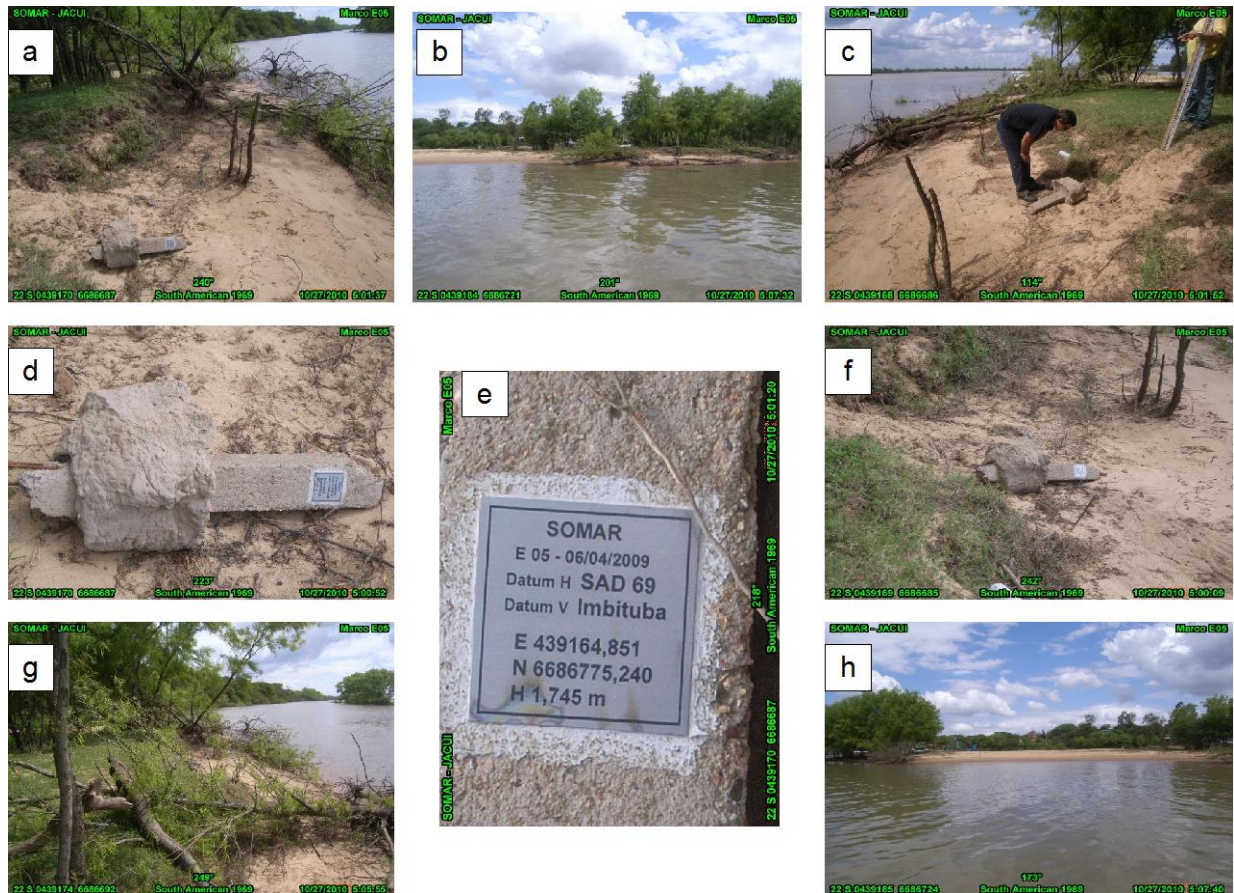
Figura 23. Marco E 05 localizado na margem esquerda do rio Jacuí, ilha Dna Antonia (a) vista da margem para montante; (b) vista da margem; (c) detalhe da margem para jusante (d) marco tombado; (e) placa de identificação; (f) vista no marco tombado com erosão do talude; (g) derrubada das árvores e h) vista geral da área.
