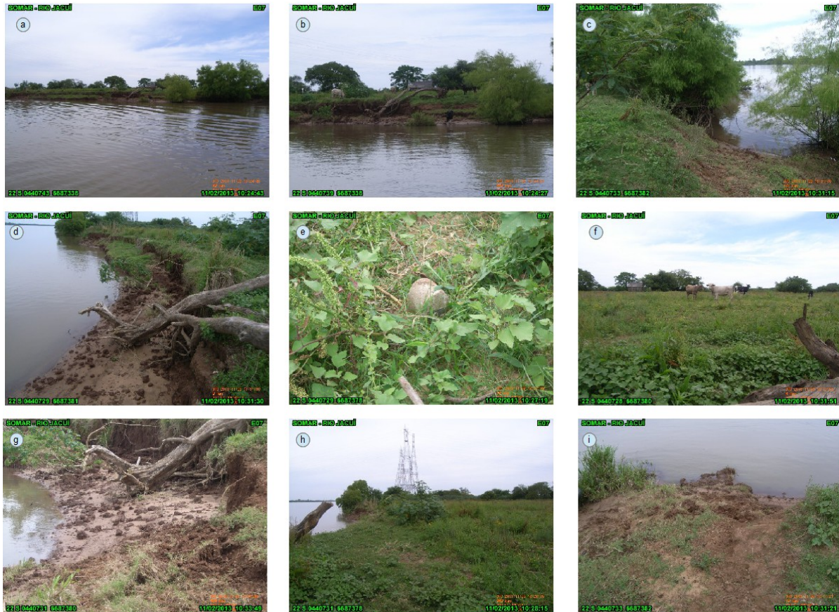
Figura 26. Imagens do Marco E07 e imediações localizado na margem esquerda do rio Jacuí, ilha das Cabras. (a) vista da margem para montante; (b) margem e local do marco; (c) vista da margem para jusante; (d) margem e talude para montante com solapamento do talude; (e) marco praticamente enterrado por deposição; (f) vista para o interior da área utilizada para o plantio de milho e gado; (g) vista da praia e talude com pisoteio do gado; (h) vista da margem para montante; (i) detalhe do talude com evidências de erosão e pisoteio do gado.
