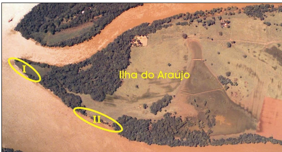
Figura 20. Áreas erodidas na ilha do Araújo, margem sudoeste (áreas "I" e "II").
