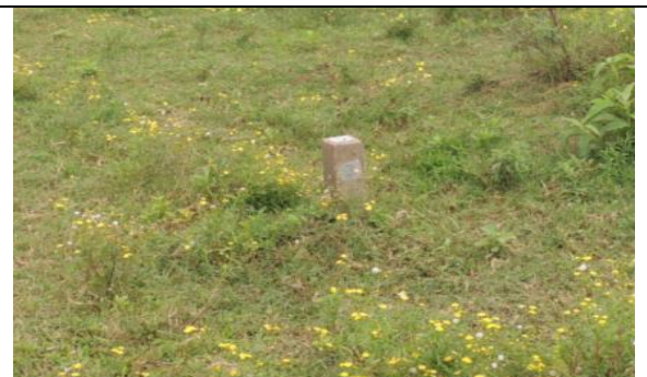
Foto 55: Marco geodésico para monitorar o recuo das margens.
