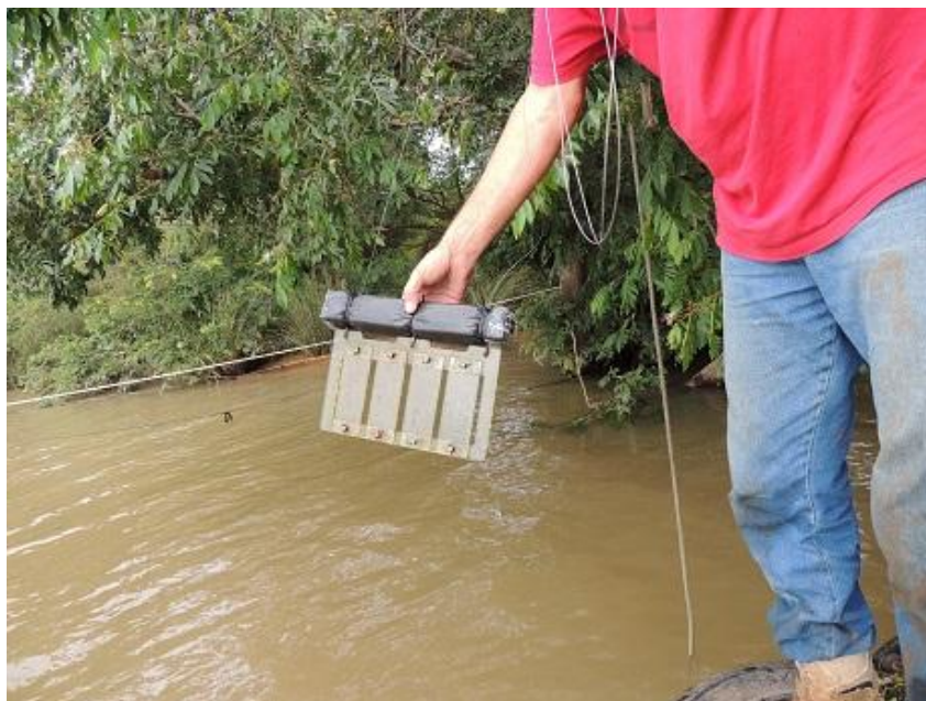
Figura 2 - Momento da retirada do amostrador em acrílico de Perifiton (em 20 de março de 2016), após 28 dias submerso no rio. Foto: M.C.Tavares.
