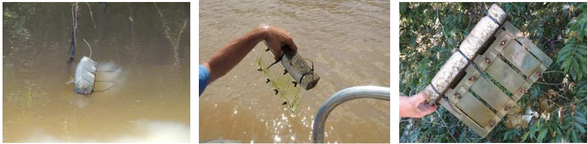
Figura 3: Amostrador em acrílico de Perifiton (no momento da coleta em 23 de novembro de 2017), após 28 dias submerso no rio. Foto: M.C.Tavares.
