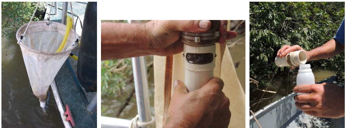
Figura 4: Amostragem de Zooplâncton com uso de rede, (em detalhe o copo como compartimento do sistema de rede), em 23 de novembro de 2017. Fotos: M.C.Tavares.
