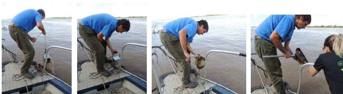
Figura 5 Amostragem de sedimento com draga de Eckman, colocação em rede de puçá para ser parcialmente lavado e colocação em saco plástico, na amostragem de primavera, em 23 de novembro de 2017. Fotos: M.C.Tavares.
