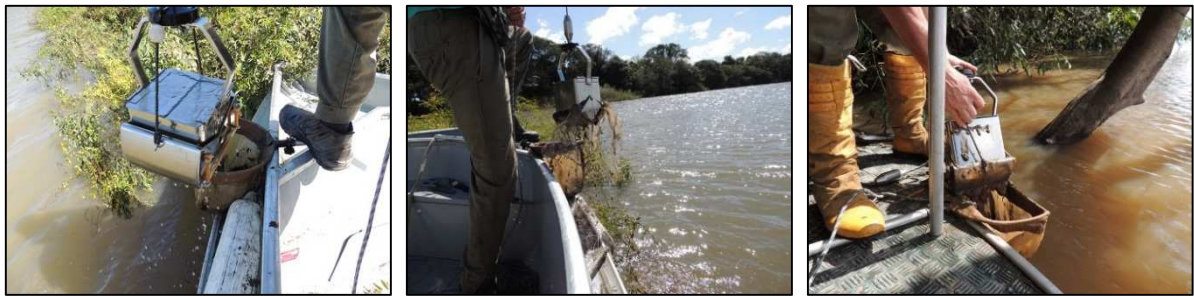
Figura 5 - Amostragem de sedimento com draga de Eckman, colocação em rede de puçá para ser parcialmente lavado e colocação em saco plástico, na amostragem de verão (22 de março) e de inverno (18 de setembro de 2018). Fotos: M.C.Tavares.
