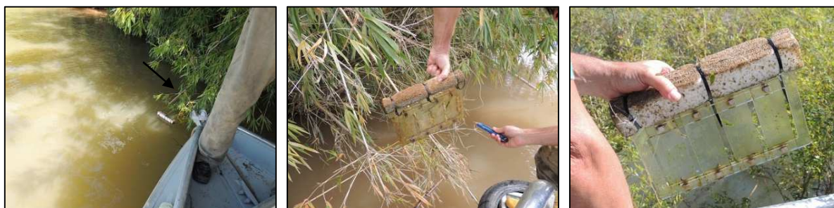
Figura 3 - Amostrador em acrílico de Perifíton (no momento da coleta em 22 de março de 2018), após 28 dias submerso no rio Jacuí. A seta indica a parte flutuante do amostrador. Foto: M.C.Tavares.
