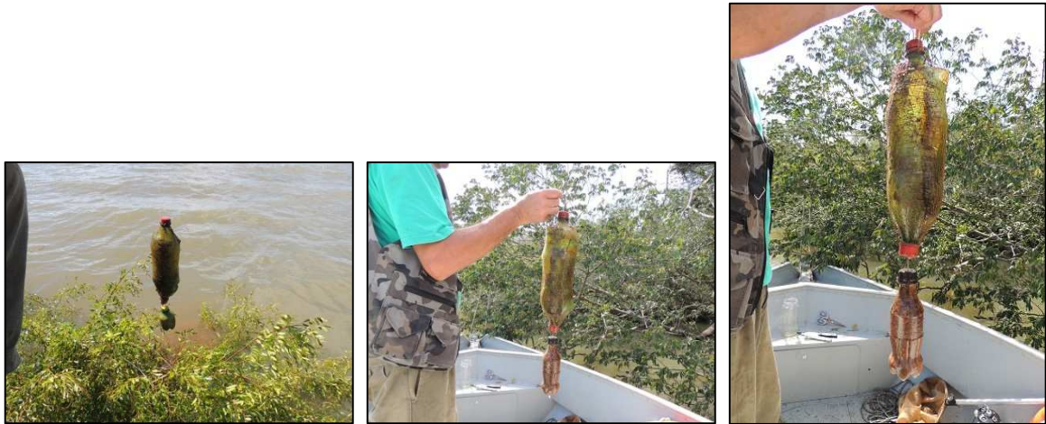
Figura 7 – Amostrador de macroinvertebrados bentônicos com uso de garrafas Pets, no momento da retirada após 60 dias submerso, em 18 de março de 2018. Foto: M.C.Tavares.
