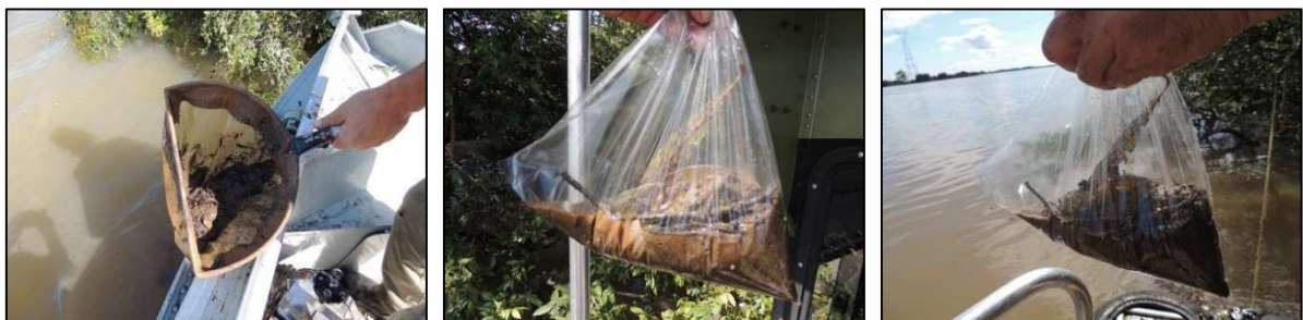
Figura 6 - Produto da dragagem em diferentes pontos de amostragem, mostrando as diferenças nos substratos analisados (com vegetação e lodo, arenosa e lodosa). Amostras fixadas com formol, acondicionadas e etiquetadas, em 18 de março de 2018. Fotos: M.C.Tavares.
