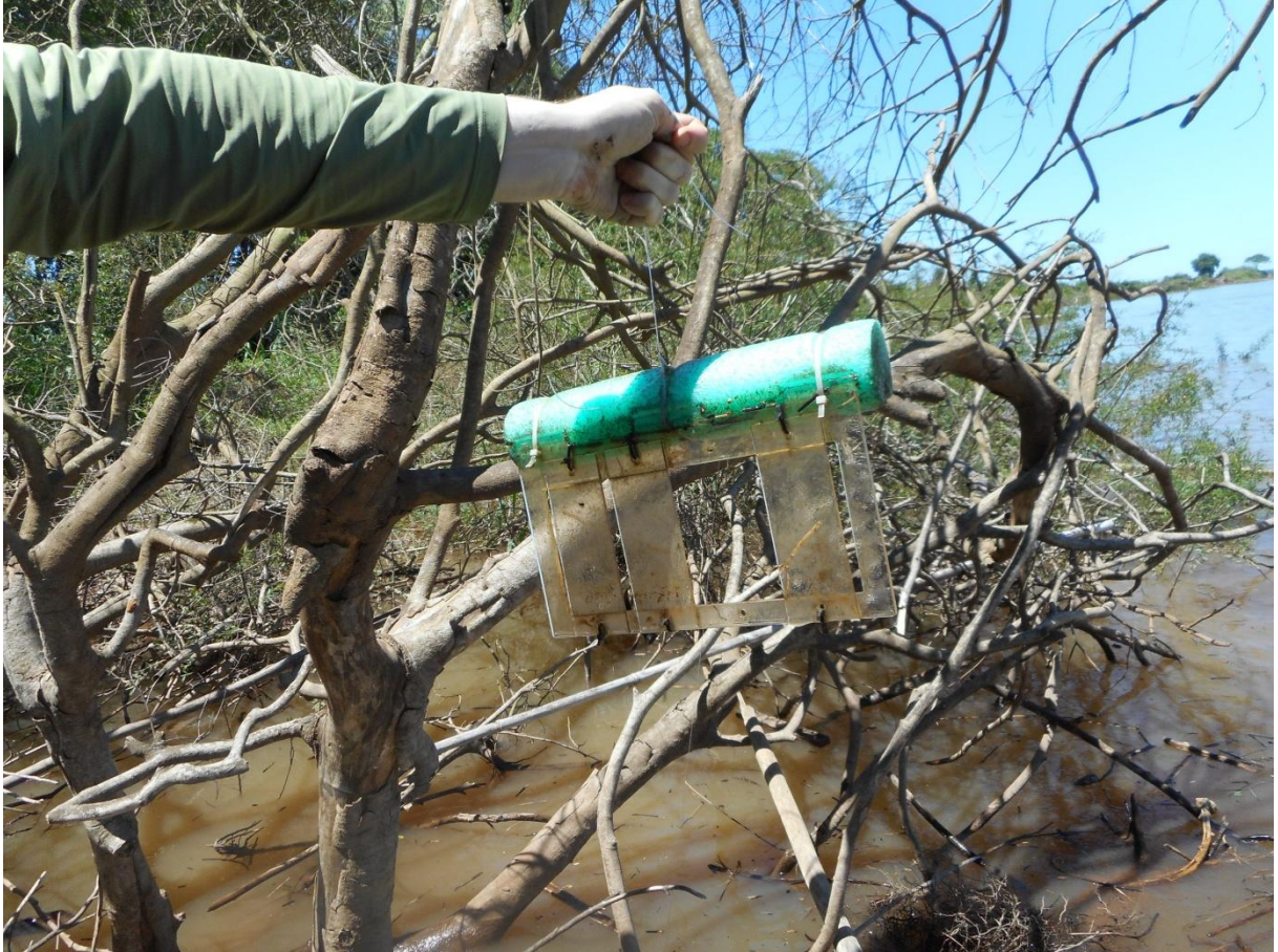
Figura 3 – Amostrador em acrílico de Perifiton (no momento da coleta em 10 de novembro de 2025), após cerca de 90 dias submerso no rio Jacuí. Foto: M.C.Tavares.
