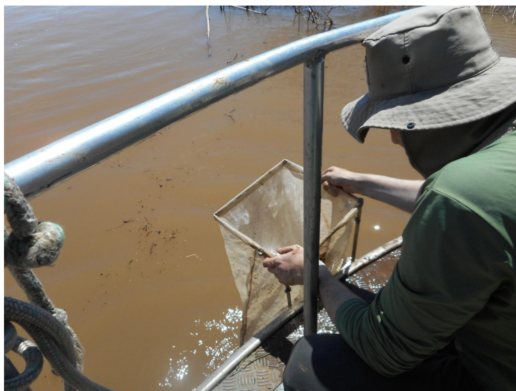
Figura 6 – Lavagem parcial do produto da dragagem, mostrando o puçá com o sedimento coletado, em 10 de novembro de 2025. Fotos: M.C.Tavares.
